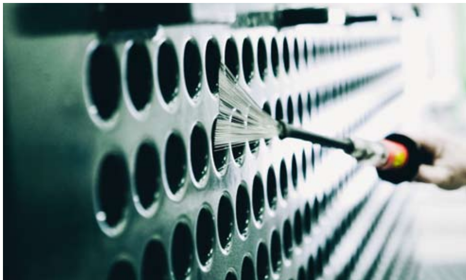
Overfladebelægning af dele til et såkaldt SNOX™-anlæg, som bruges til røggasrensning på kraftværker, foto udlånt af Acccoat.
